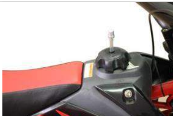
3.11.1. Установите крышку бензобака, как показано на фотографии.
