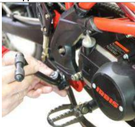
3.12.1 Установите кик-стартер на вал кик-стартера.
