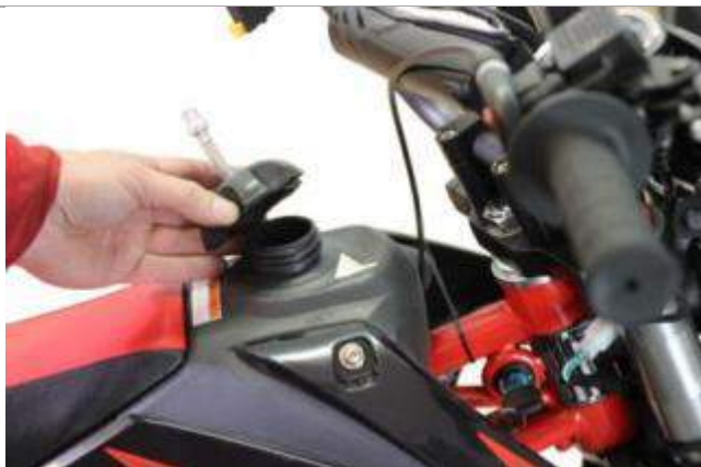
3.11.1. Установите крышку бензобака, как показано на фотографии.
