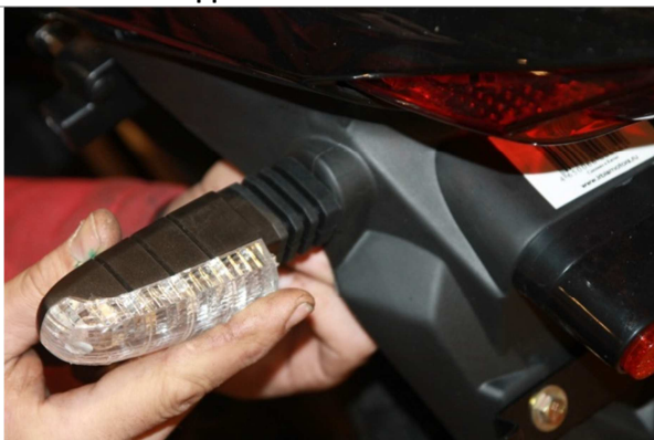
3.14.1. Устанавливаем указатель поворотов. Фиксируем его гайкой.
