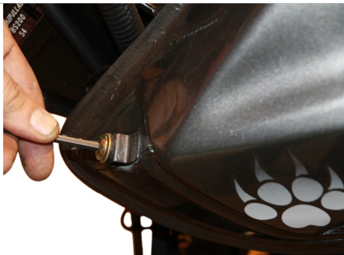
3.13.1. Для установки защиты цепи необходимо открутить два винта, указанных на фотографиях.
