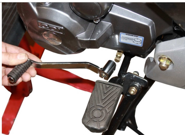
3.15.2. Устанавливаем педаль переключения передач так, как указано на рисунке.
