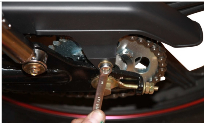
3.12.4. Фиксируем её с помощью двух ранее выкрученных болтов.
