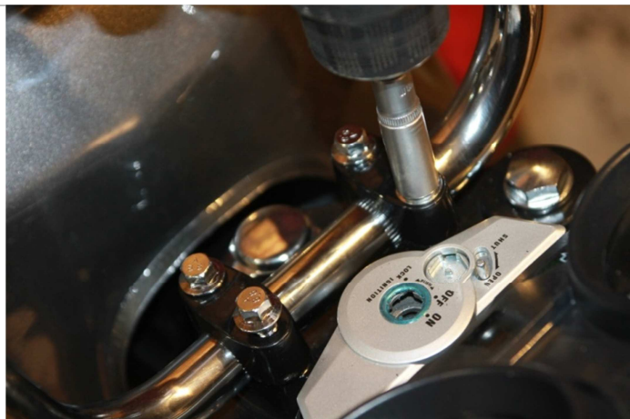
3.2.4. Отрегулировав руль в нужное положение, закрутите болты крепления.
