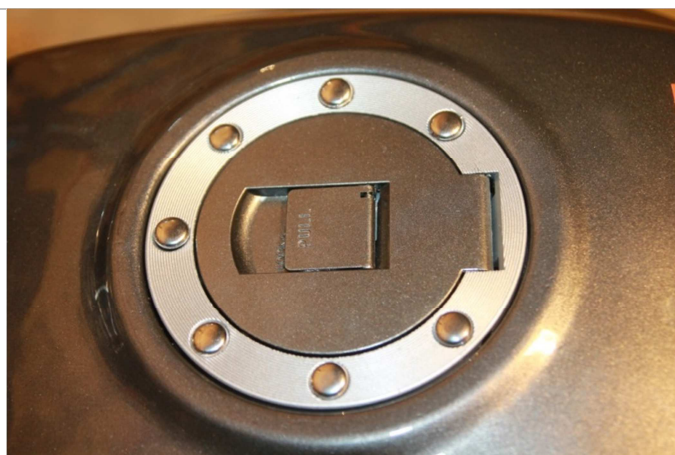
3.19.1. Установите декоративные заглушки винтов бака так, как указано на рисунке.
