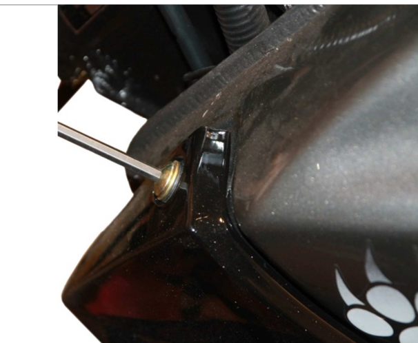
3.13.3. Фиксируем её с помощью двух ранее выкрученных винтов.
