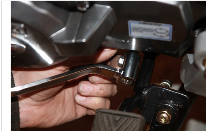
3.15.3. Фиксируем педаль болтом. Закручиваем его с помощью ключа.
