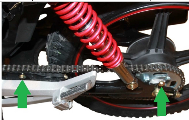
3.12.1. Для установки защиты цепи необходимо открутить два болта, указанных стрелками.
