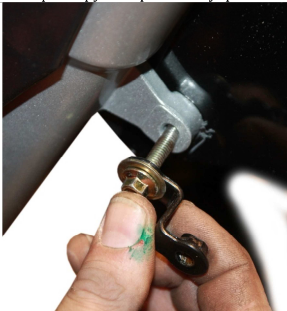
3.16.6. С наружи крыло крепится двумя длинными болтами. Обратите внимание, что данными болтами также крепится кронштейн крепления катафота.
