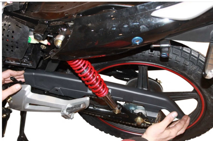
3.12.3. Устанавливаем защиту цепи.
