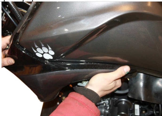
3.13.2. Устанавливаем боковой пластик.
