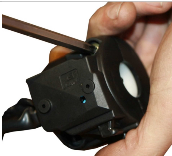
3.3.1. С помощью крестовой отвертки с нижней части левого блока переключателей выкручиваем два винта.
