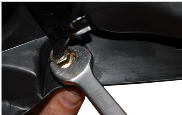
3.14.2. Выравниваем указатель поворотов. Закручиваем гайку.
