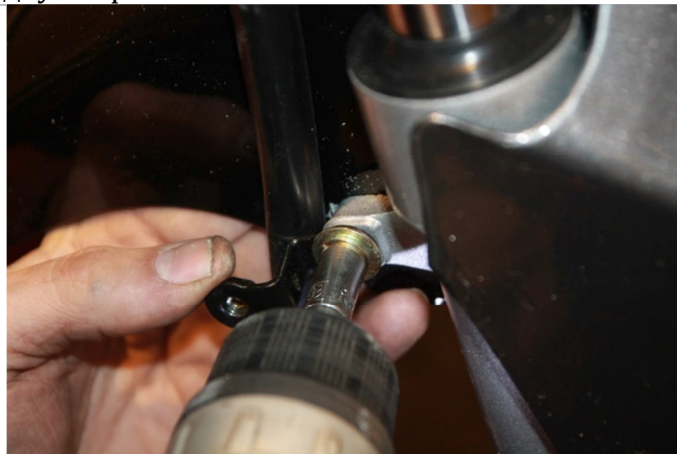
3.16.5. Зафиксируйте крыло изнутри с помощью двух коротких болтов.
