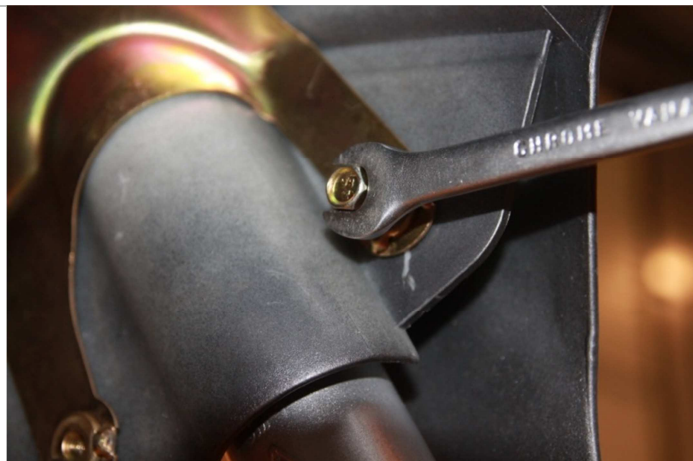
3.16.5. Зафиксируйте крыло изнутри с помощью двух коротких болтов.
