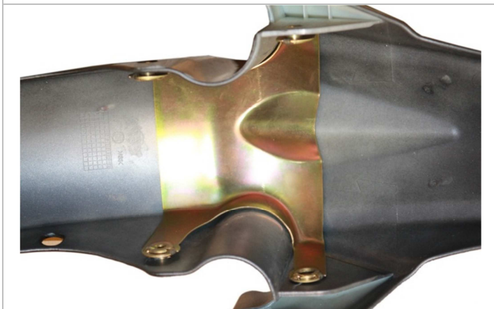
3.16.3. Устанавливаем кронштейн крепления крыла так, как указано на рисунке.
