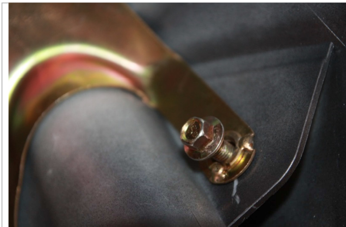
3.16.5. Зафиксируйте крыло изнутри с помощью двух коротких болтов.
