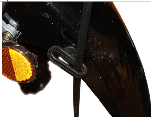
3.16.8. Устанавливаем фиксатор троса привода спидометра в технологическое отверстие в крыле.
