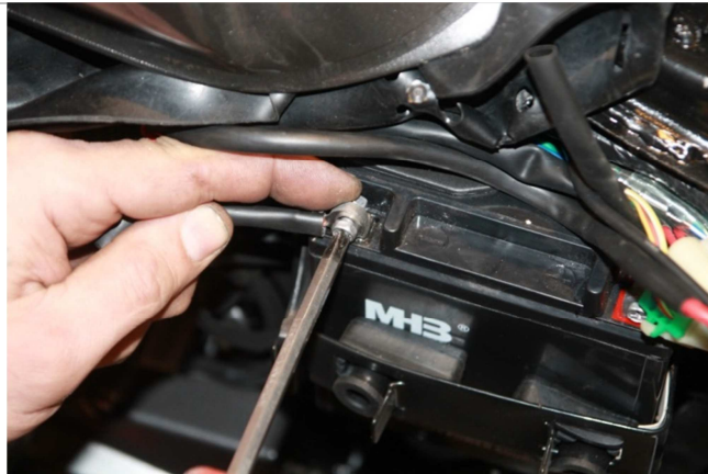
3.11.3. Установите клеммы согласно полярности, где красный это «+», Установите клеммы согласно полярности, где красный это «+», черный соответственно «-».
