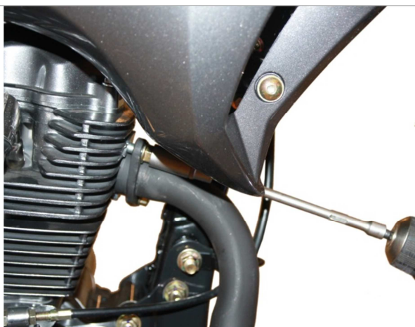
3.9.6. Закручиваем гайки, крепящие глушитель к головке блока цилиндров.
