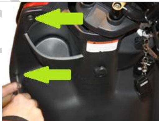
3.7.7. Зафиксируйте пластик с обратной стороны саморезами из комплекта крепежа (места креплений указаны стрелками). С правой стороны скутера места креплений аналогичны.
