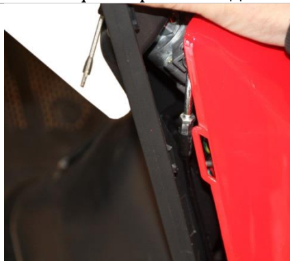
3.7.5. Обратите внимание на пластиковые «ушки» блок-фары, которые должны защёлкнуться при установке на корпусе.
