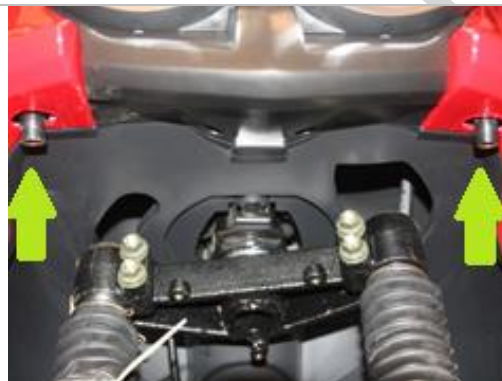
3.7.6. Обратите внимание на установку пластика блок-фары в нижней части. Бочонки должны быть вставлены в выломанные отверстия .
