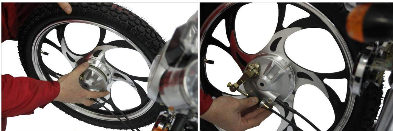
Поставьте колесо между двух передних вилок амортизаторов.
