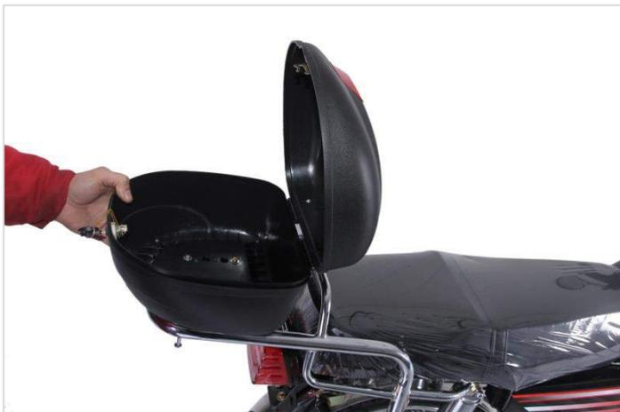
С нижней стороны зафиксируйте болты гайками через крепёжные планки за багажник
