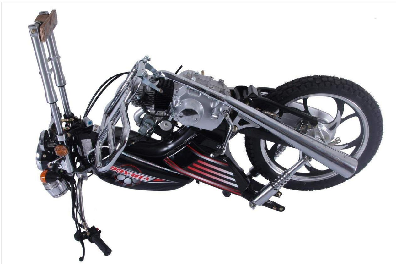
Снимите выхлопную трубу, открутив болт крепления выпускной системы (рис.1) и два болта крепления выпускной трубы к головке цилиндра (рис.2).
