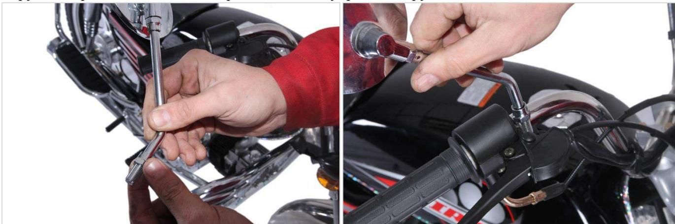
Зафиксируйте гайки ключом
