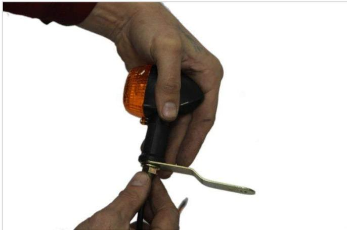
**КОМПЛЕКТУЮЩИЕ:** №25. ПЛАСТИНА КРЕПЛЕНИЯ ЗАДНИХ ПОВОРОТНЫХ ОГНЕЙ К ЗАДНЕМУ КРЫЛУ × 2 ШТ., № 28 ЗАДНИЙ УКАЗАТЕЛЬ ПОВОРОТОВ × 2 ШТ.
