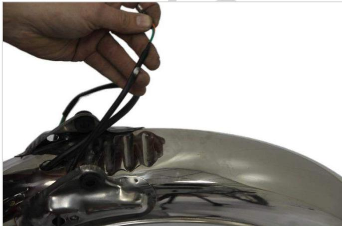
Закрепите кронштейны болтами на заднем крыле (болты предварительно надо выкрутить из штатных мест)
