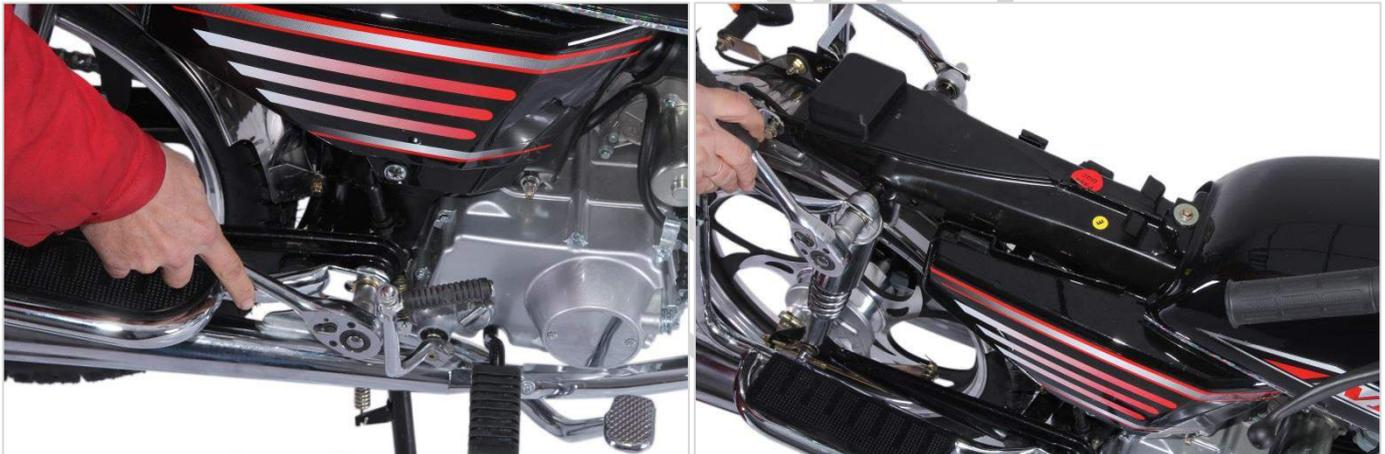
🔧 ТРЕЩОТКА БОЛ.+ ГОЛОВКА НА 17ММ.+ ГОЛОВКА НА 14ММ.
