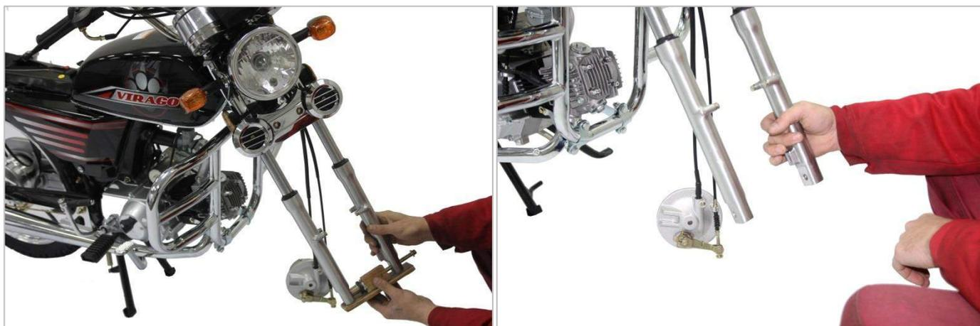
На осевом болте также находится шестерня привода спидометра и втулка.
