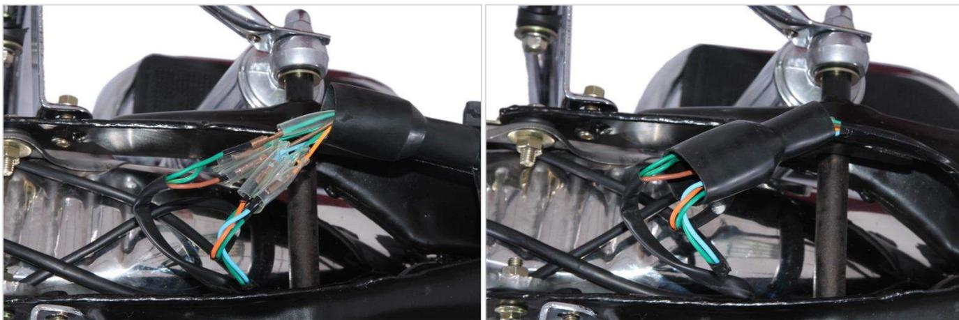
**Внимание! После подсоединения проводов проверьте работу всех электроприборов (указателей поворотов, звукового сигнала и стоп сигналов). Проверка необходима на этом этапе т.к. максимально доступна контактная группа.**
