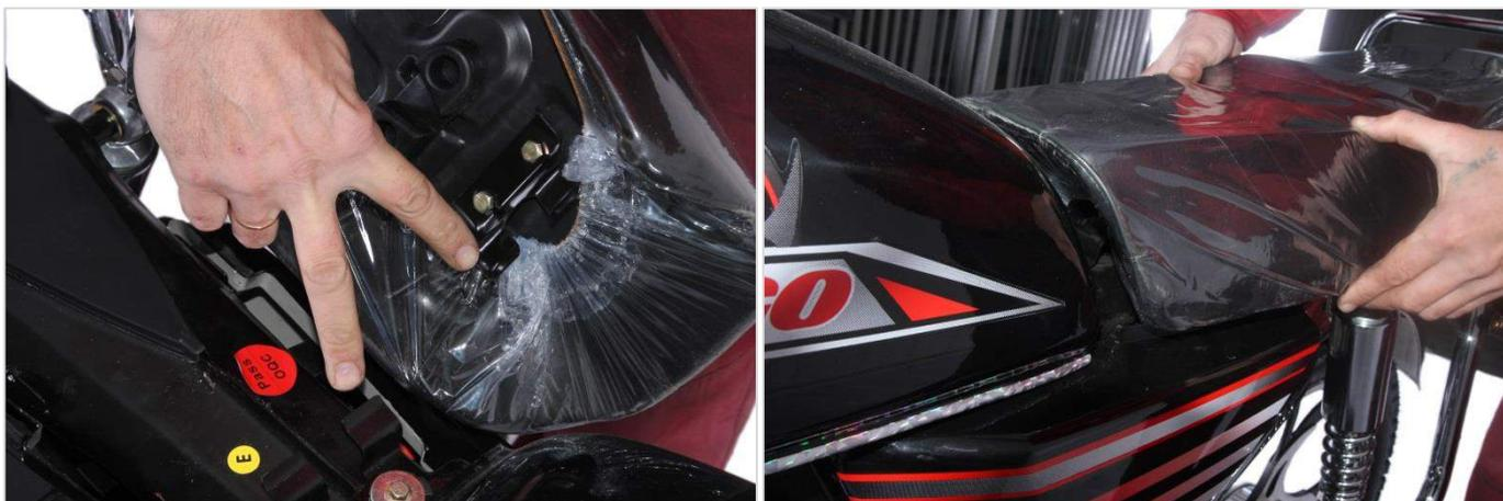
Заднюю часть сиденья фиксируем болтами крепления багажника к раме.
