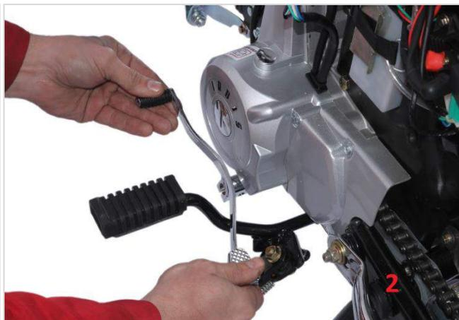
Зафиксируйте рычаг болтом
