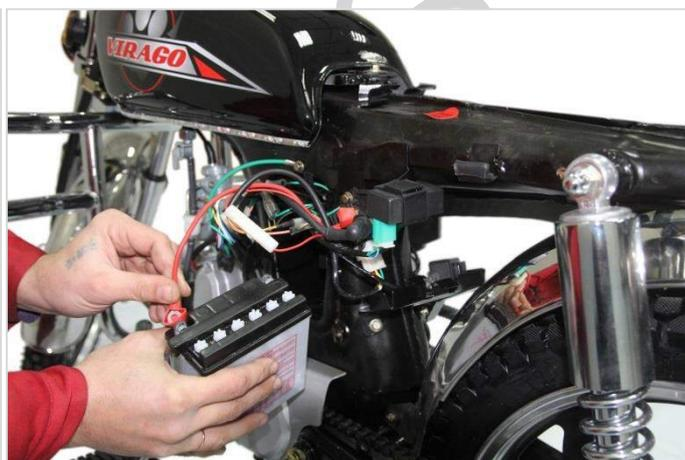
**Внимание! В комплекте поставки АКБ не заправлена электролитом. Требуется залить электролит перед использованием.**
