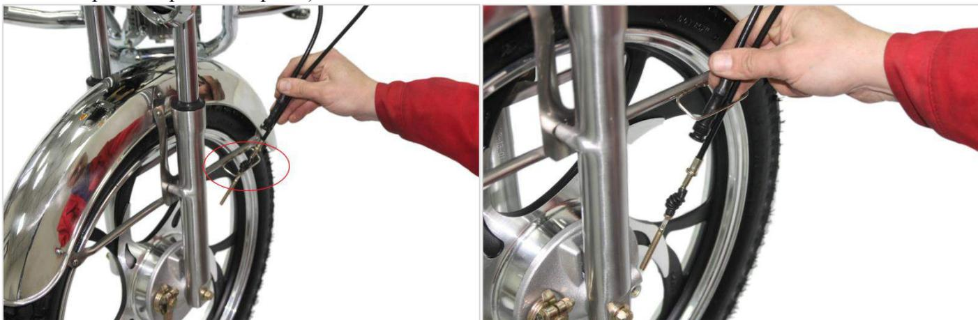
Подсоедините тросик спидометра, вставив его в штатное отверстие (рис.1) и зафиксируйте крепёжным болтом (рис.2)
