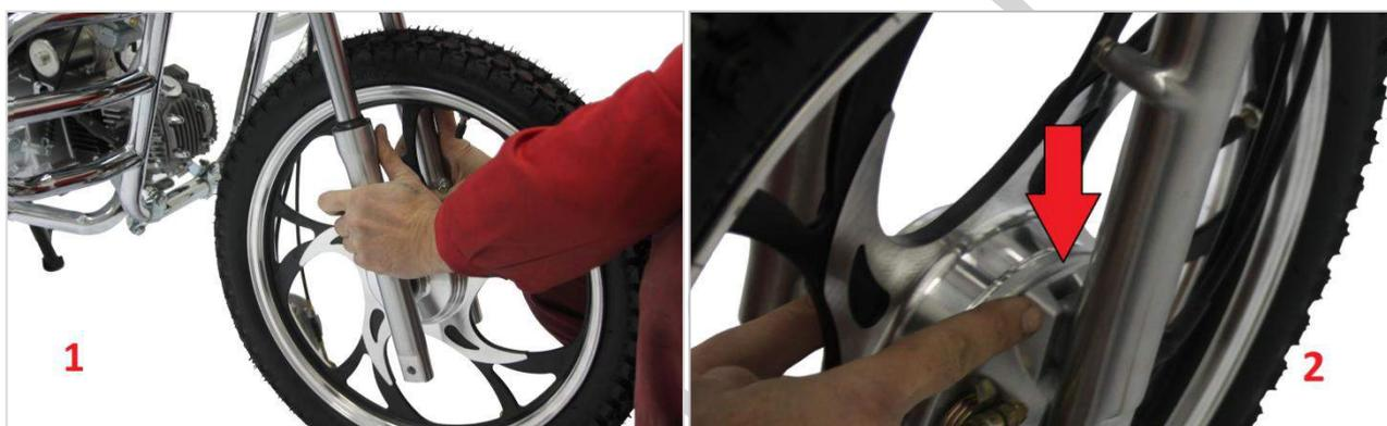
Вставьте осевой болт в левую вилку и проденьте через тормозной барабан.
