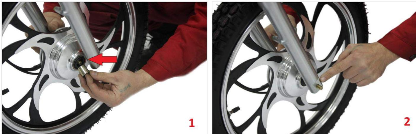
Закрутите фиксирующую гайку с правой стороны колеса (рис.1) и затяните ключом (рис.2)
