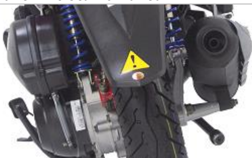
3.3.5. Аналогично установите амортизатор с левой стороны. Скутер будет иметь вид, как показано на рисунке.
