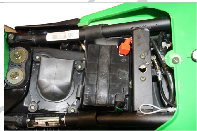
3.7.3. Установите клеммы согласно полярности, где красный это «+», установите клеммы согласно полярности, где красный это «+», черный соответственно «-». Строго соблюдайте полярность! Не соединяйте «+» и «-» вместе, это может привести к короткому замыканию и возгоранию мотоцикла, выходу из строя его электрических частей. Аккуратно уложите провода в свободном промежутке между АКБ и кузовом. Зафиксируйте АКБ.
