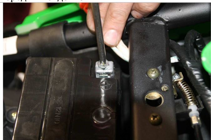
3.7.3. Установите клеммы согласно полярности, где красный это «+», установите клеммы согласно полярности, где красный это «+», черный соответственно «-». Строго соблюдайте полярность! Не соединяйте «+» и «-» вместе, это может привести к короткому замыканию и возгоранию мотоцикла, выходу из строя его электрических частей. Аккуратно уложите провода в свободном промежутке между АКБ и кузовом. Зафиксируйте АКБ.
