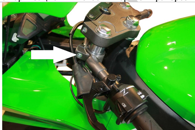
3.1.6. Открутите винты крепления ручек руля, указанных стрелками.
