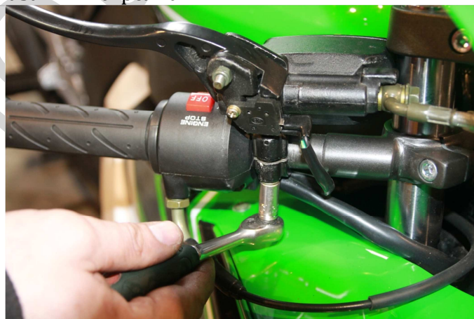
3.1.8. Для правильной установки руля необходимо открутить болты хомута ручки переднего тормоза.
