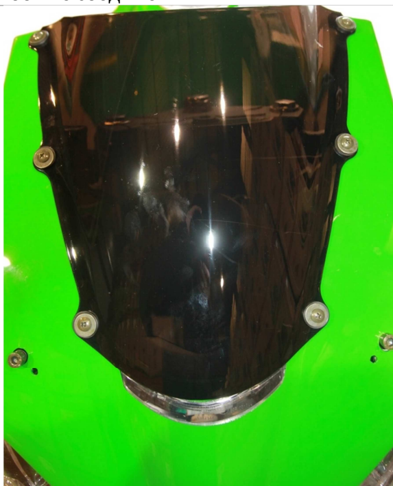
3.3.5. Правильно установленное лобовое стекло имеет вид, как указано на рисунке.
