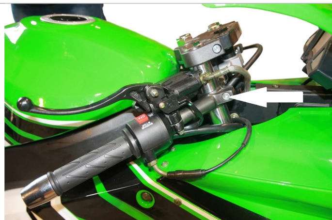
3.1.6. Открутите винты крепления ручек руля, указанных стрелками.
