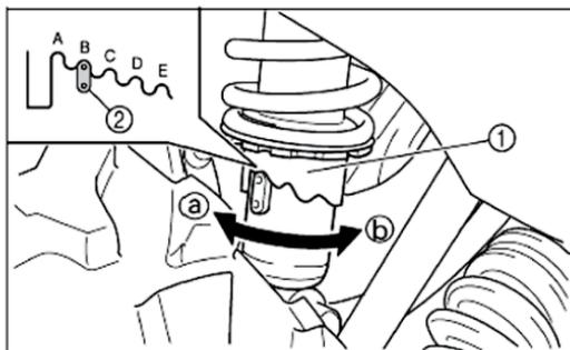
1. Кольцо регулировки жесткости пружины.
