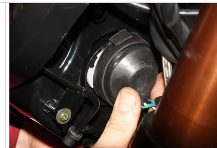
3.5.2. Одеваем резиновую защиту патрона лампы фары.
