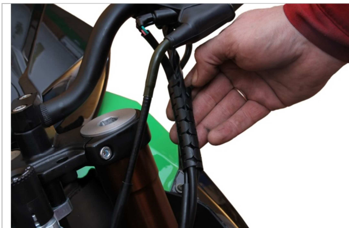
3.4.1. Сводим все провода и тросы (за исключением троса сцепления) вместе и закрепляем с помощью пластикового хомута крепления.
