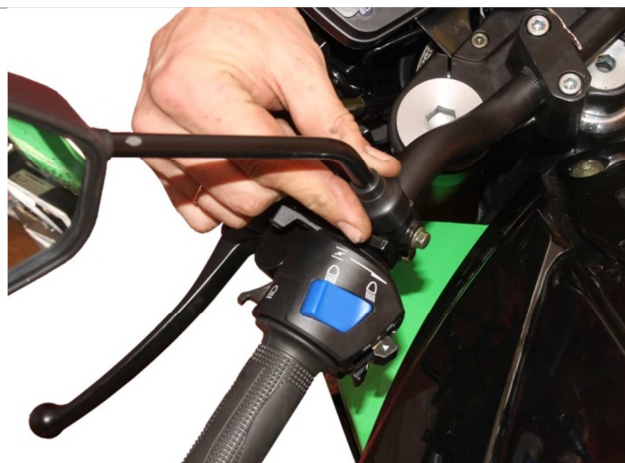
3.17.4. Оденьте на гайку декоративный резиновый колпачок. После этого отрегулируйте зеркало.
