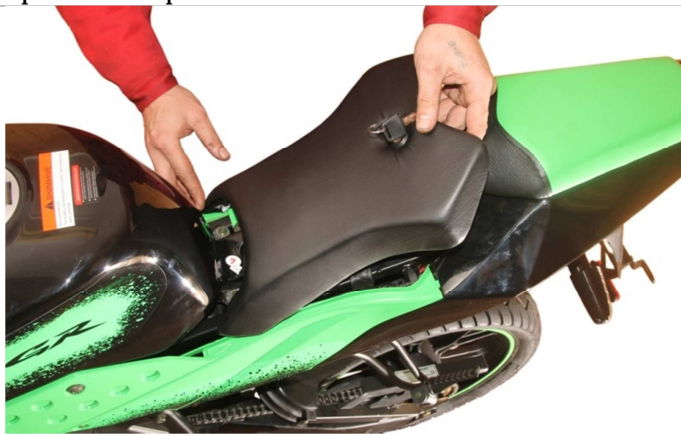
3.16.5. Устанавливаем сиденье водителя.
