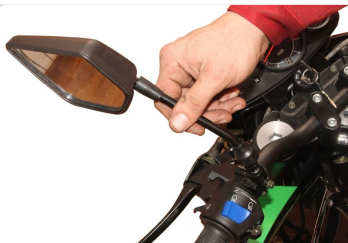
3.17.1. Вкрутите зеркала в штатные отверстия в блоках управления руля.
