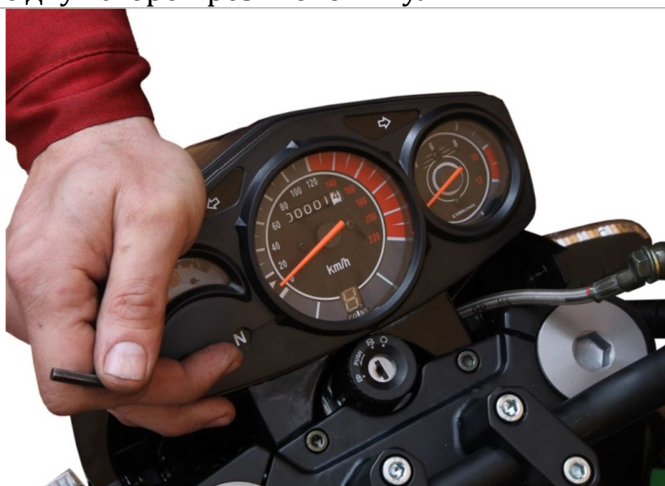
3.5.11. Выровняйте приборную панель.
