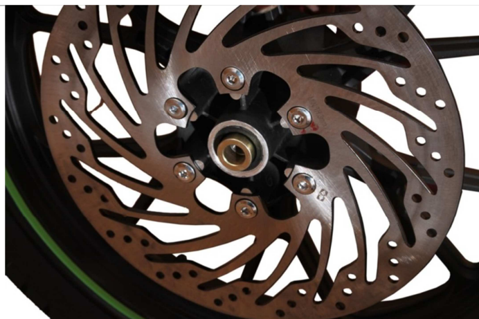
3.7.6. Диск после установки втулки должен иметь вид, как представлено на рисунке.
