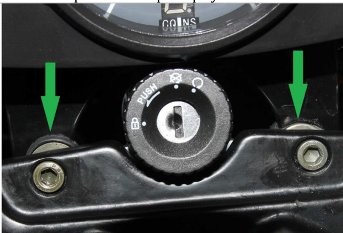
3.5.13. Во избежание разрушения резиновых прокладок, болты крепления приборной панели не рекомендуется перетягивать. После затяжки винтов резиновые прокладки должны иметь вид, как показано на рисунке.
