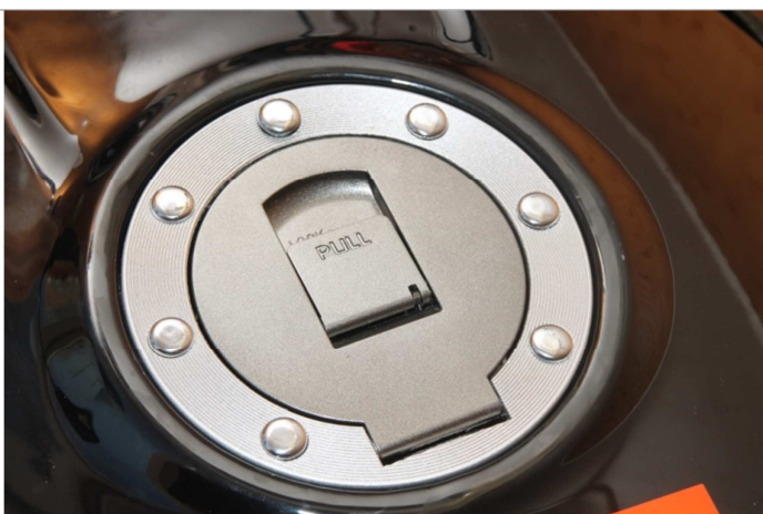
3.18.2. После установки декоративных заглушек винтов, лючок бензобака будет иметь вид, как показано на рисунке.
