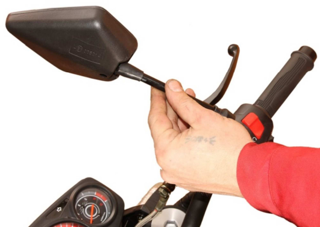
3.17.1. Вкрутите зеркала в штатные отверстия в блоках управления руля.
