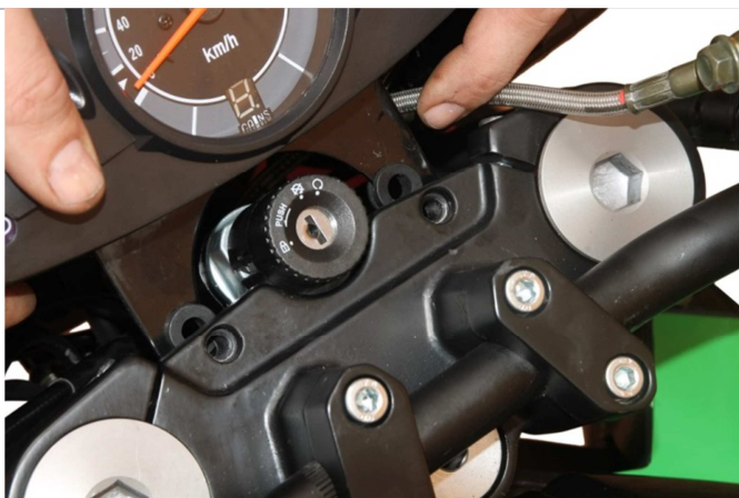
3.5.8. Устанавливаем блок фары на место так, чтобы совпали крепежные отверстия в траверсе руля и резиновых втулках.
