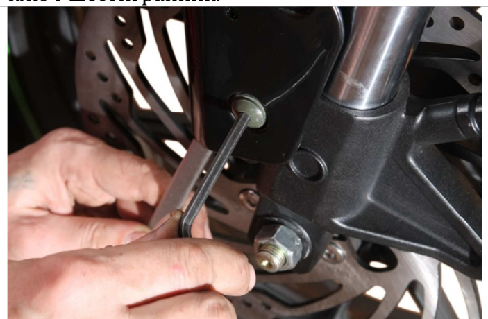
3.8.5. Прикручиваем крыло. Обратите внимание, что в верхней точке крепления используется короткий болт без гайки, в нижней – длинный болт с гайкой.
