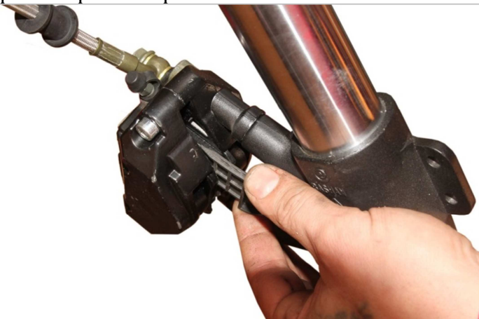
3.7.4. Из механизма переднего дискового тормоза вытащите транспортировочную заглушку, препятствующую сведению колодок.
