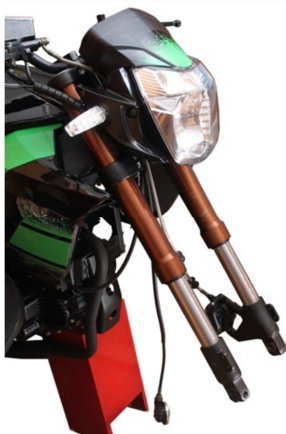
3.7.3. Для удобства установки колеса с помощью помощника приподнимите мотоцикл и подставьте под двигатель подставку. Мотоцикл должен быть надежно закреплен в данном положении!
