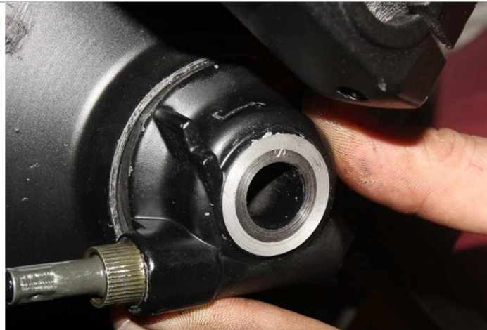
3.7.9. Привода спидометра должен быть установлен так, как представлено на рисунке.
