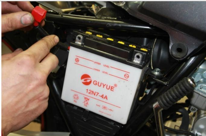
3.6.9. Установите клеммы согласно полярности, где красный это «+», установите клеммы согласно полярности, где красный это «+», черный соответственно «-». **Строго соблюдайте полярность!** Не соединяйте «+» и «-» вместе, это может привести к короткому замыканию и возгоранию мотоцикла, выходу из строя его электрических частей. Аккуратно уложите провода в свободном промежутке между АКБ и кузовом. Зафиксируйте АКБ.
