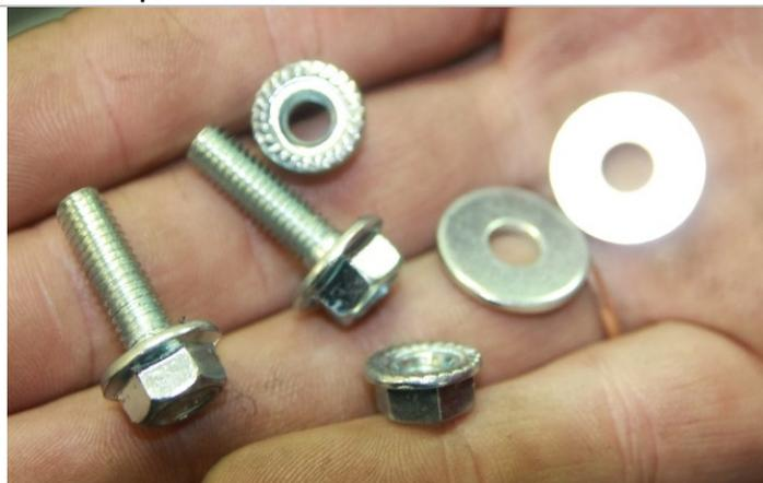
3.4.1. Для установки заднего крыла используются болты М10 (2 шт.), гайки (2 шт.) и шайбы (2 шт.) под данные болты.
