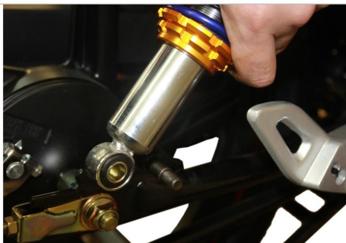
3.2.1. Для установки в рабочее положение маятника задней подвески используем гайку (2 шт.) и шайбу (2 шт.) идущих в комплекте поставки.
