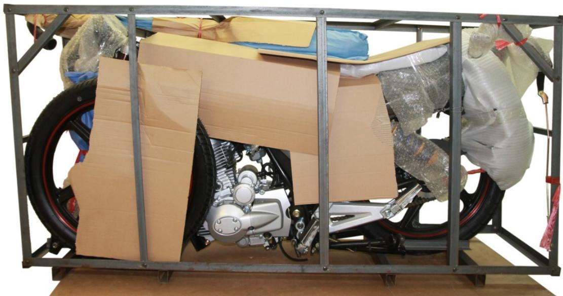
Мотоцикл поставляется в частично разобранном виде. Достаньте идущие в комплекте части мотоцикла и коробки с комплектующими. Раскрутите болты металлического каркаса.
