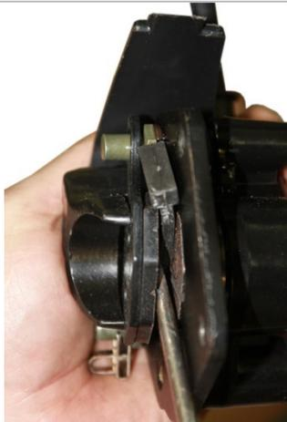
3.9.1. Из механизма переднего дискового тормоза вытащите транспортировочную заглушку, препятствующую сведению колодок.
