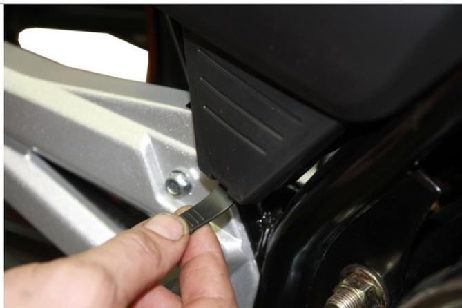
3.6.2. Для открытия инструментального ящика необходимо потянуть за «язычок» крышки инструментального ящика.
