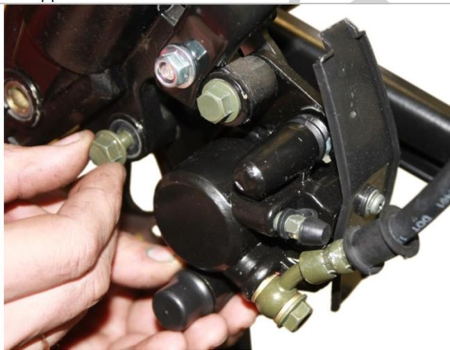
3.9.3. Устанавливаем суппорт переднего тормоза и фиксируем его двумя болтами из комплекта крепежа. Затяните болты крепления суппорта.
