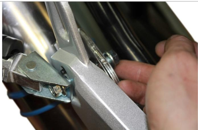
3.7.6. Для этого необходимо кронштейн крепления глушителя зафиксировать с помощью болта, крепящего правую подножку пассажира.
