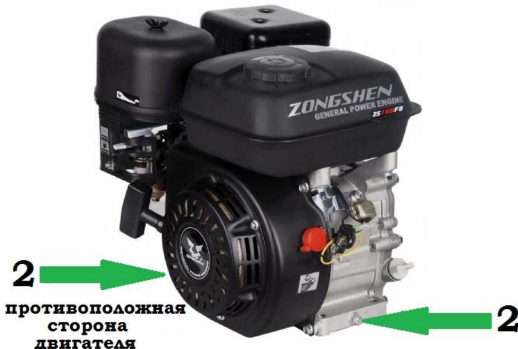
Для обеспечения полного слива отработанного масла снимите двигатель с мотобуксировщика и установите на ровную горизонтальную поверхность так, чтобы обеспечивался доступ к заглушкам сливного отверстия (2). Для слива масла выверните масляный щуп (1, стр. 15) и заглушки сливного отверстия (2) с помощью ключа на 17". Дождитесь, пока масло стечет полностью. Закрутите заглушки сливных отверстий.
