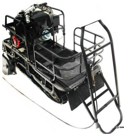
10. Демонтируем быстросъемный болт крепления багажника.
