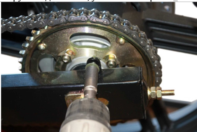
3.5.3. Откручиваем указанные болты.
