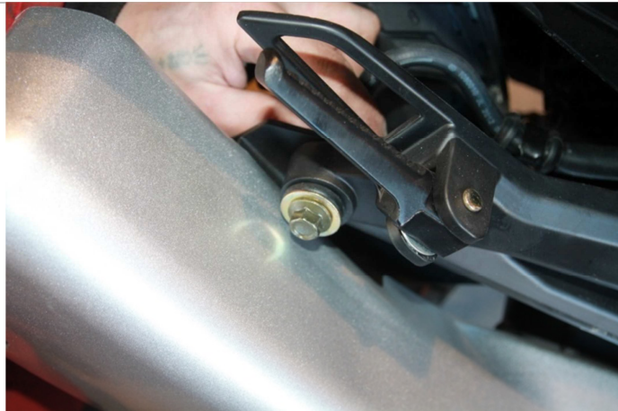
3.12.5. Крепим глушитель в задней части мотоцикла. Для этого необходимо кронштейн крепления глушителя зафиксировать с помощью болта в месте его крепления, расположенного на правом кронштейне крепления подножки пассажира.
