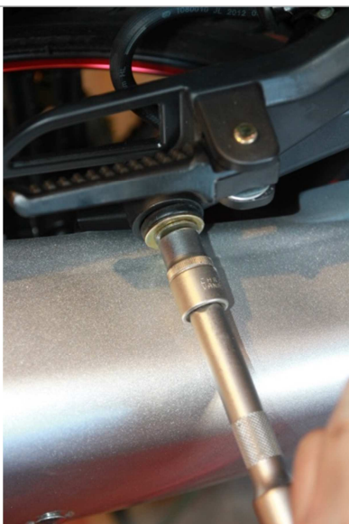
3.12.7. Закручиваем гайку крепления глушителя к кронштейну задней подножки.
