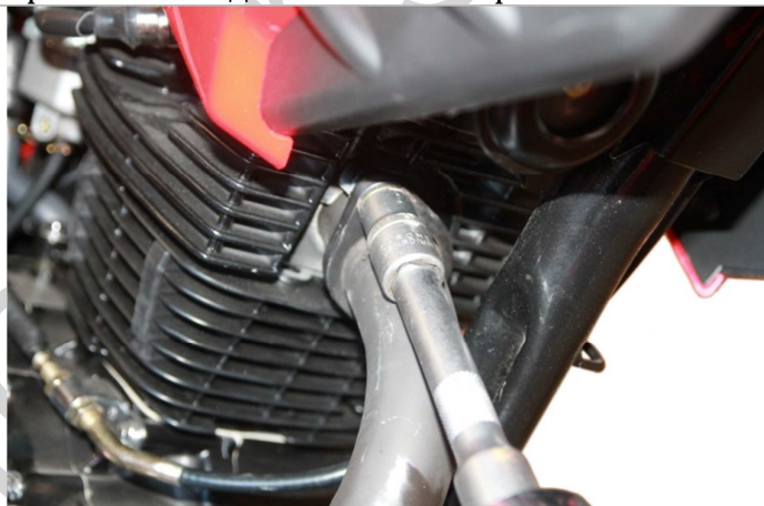
3.12.6. Фиксируем глушитель к головке блока его с помощью двух гаек из комплекта крепежа. Закручиваем гайки.
