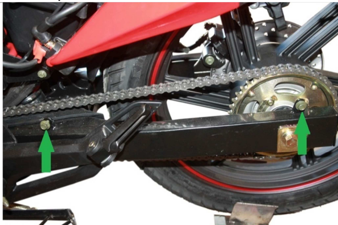
3.5.1. Для установки защиты цепи необходимо открутить два болта, указанных стрелками.
