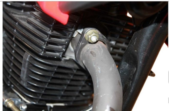
3.12.6. Фиксируем глушитель к головке блока его с помощью двух гаек из комплекта крепежа. Закручиваем гайки.
