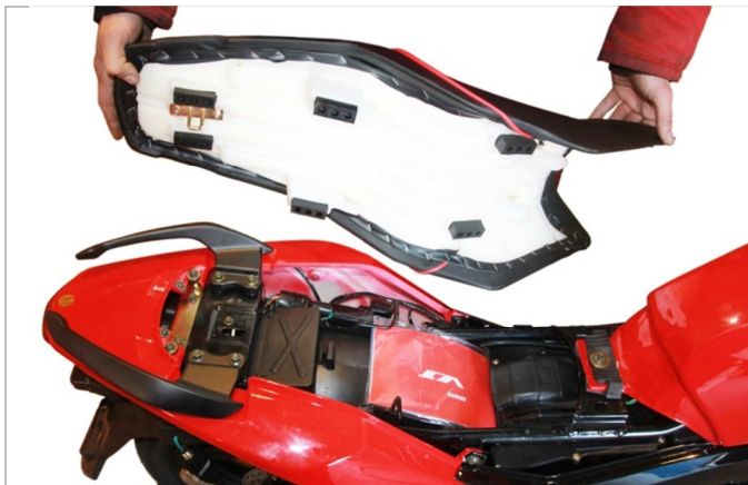
3.7.1. Устанавливаем сиденье на место.
