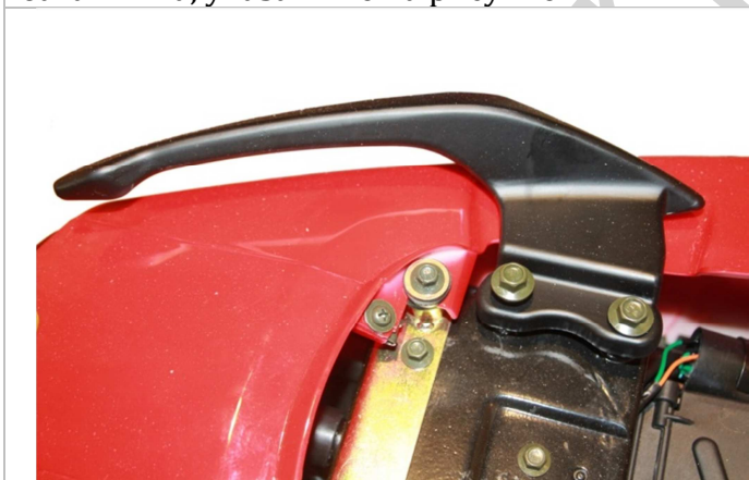
3.6.3. Багажник фиксируется с помощью ранее выкрученных болтов.
