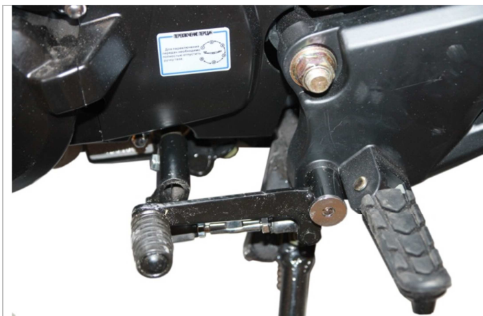
3.12.5. Правильно установленная педаль имеет вид, указанный на рисунке.
