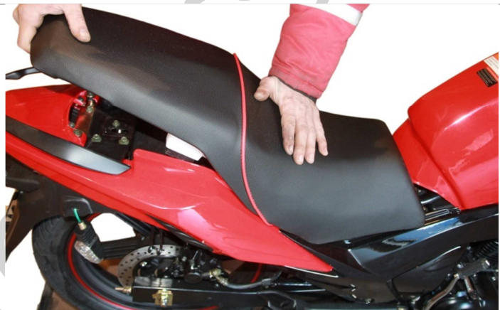
3.7.2. Для этого нажимаем на переднюю часть сиденья и подаем его вперед.
