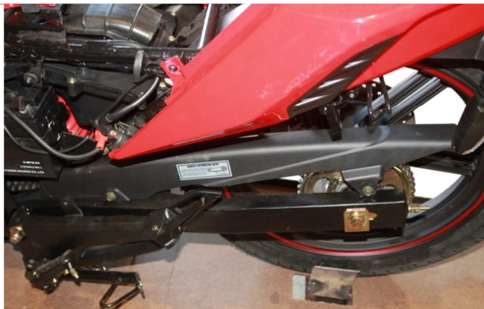
3.5.6. Правильно установленная защита выглядит так, как указано на рисунке.
