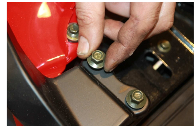
3.6.3. Багажник фиксируется с помощью ранее выкрученных болтов.
