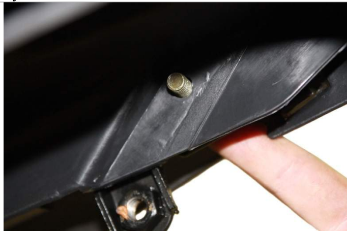
3.8.11. Устанавливаем обратно и закручиваем болт с гайкой, выкрученные ранее в пункте 3.8.2.
