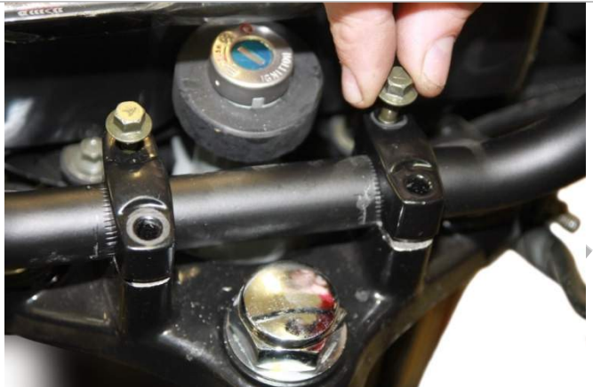
3.1.2. Установите хомуты крепления руля в соответствии с рисунком. Наживите верхние болты крепления.
