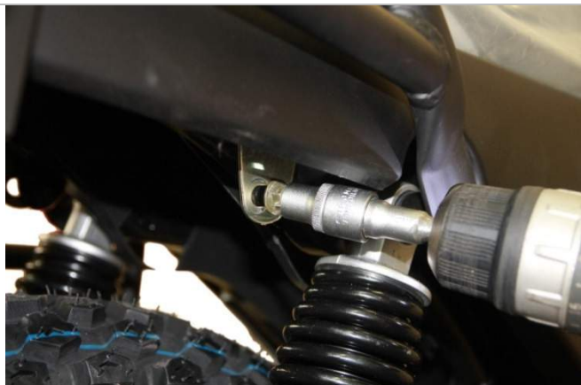
3.23.3. Закручиваем ранее выкрученные болты крепления сиденья.
