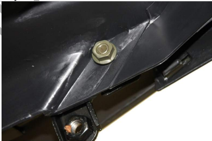
3.8.11. Устанавливаем обратно и закручиваем болт с гайкой, выкрученные ранее в пункте 3.8.2.
