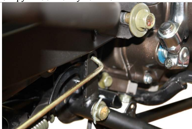
3.19.7. Пропускаем «г»-образную часть тяги через кронштейн педали тормоза.
