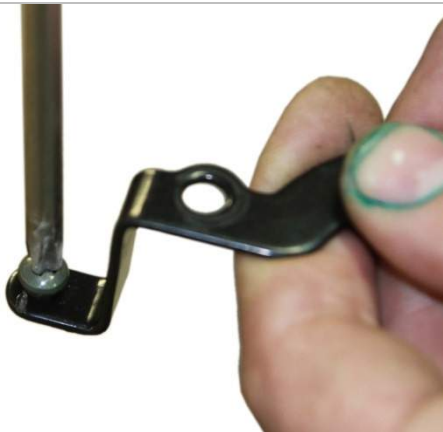
3.1.3. Открутите два винта крепления указателя уровня топлива к кронштейну его крепления.
