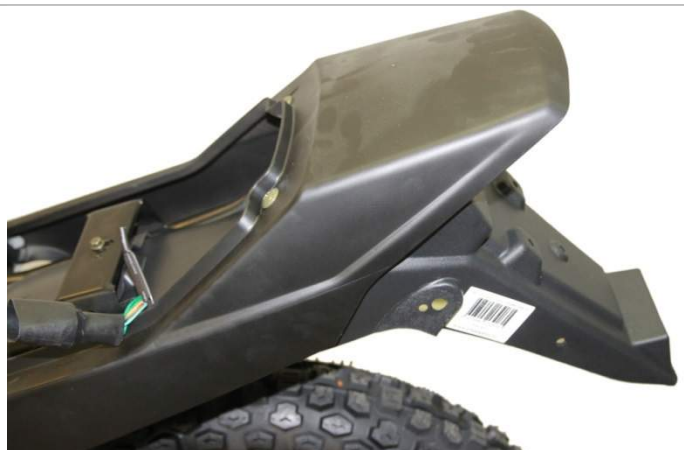
3.8.8. Правильно установленное крыло выглядит так, как указано на фотографии.
