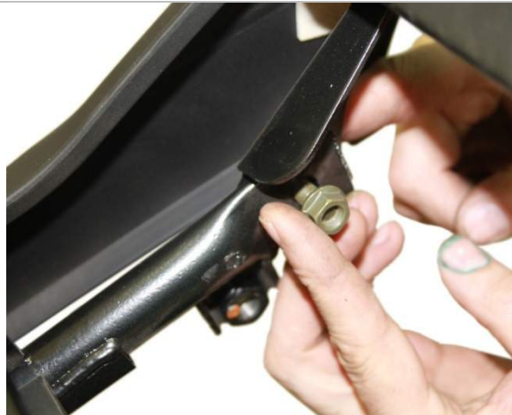
3.8.2. С левой и правой сторон мотоцикла откручиваем указанные на фотографии болт с гайкой.
