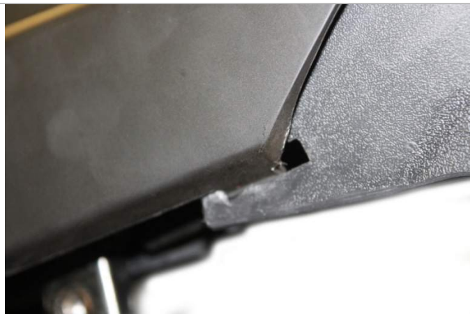
3.8.7. Правильно соединенный задний пластик с пластиком крыла выглядит так, как указано на рисунке.
