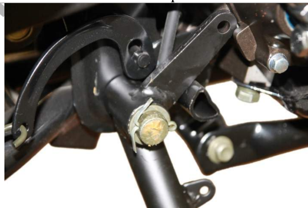
3.19.4. Фиксируем педаль с помощью шплинта.
