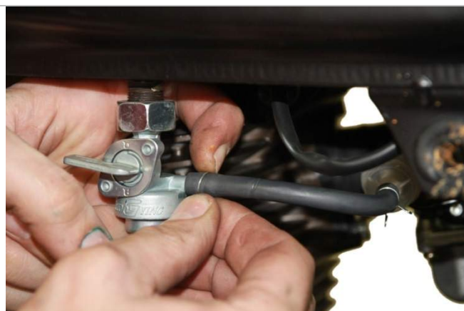
3.21.3. Установите шланг, идущий от бензобака к топливному крану. Зафиксируйте его металлическим хомутом.
