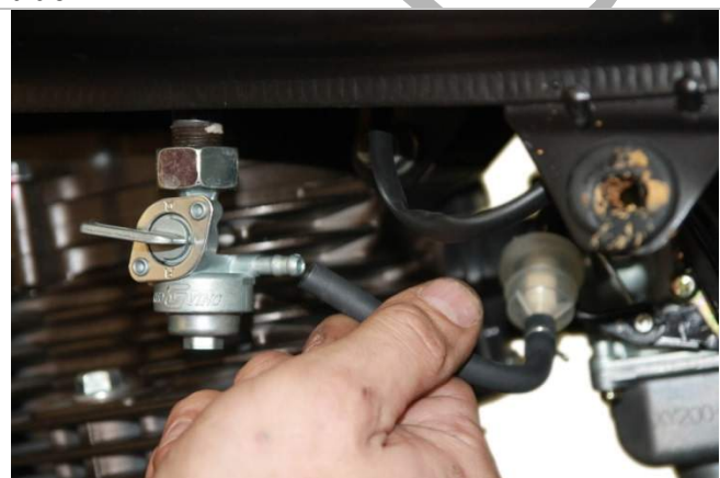
3.21.3. Установите шланг, идущий от бензобака к топливному крану. Зафиксируйте его металлическим хомутом.
