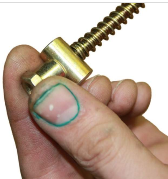
3.19.5. Для установки тяги привода заднего тормоза к тормозному механизму откручиваем гайку на тяге.
