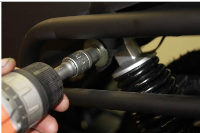
3.20.8. Закручиваем гайку крепления заднего багажника и амортизатора.
