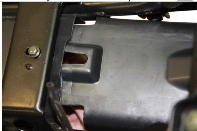
3.8.5. Устанавливаем крыло. Верхнюю часть крыла необходимо завести между пластиковым подкрылком и металлической шайбой, указанными в пункте 3.8.3.
