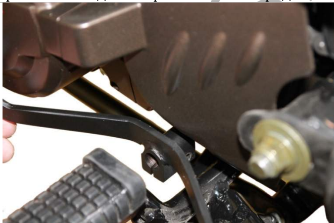
3.23.3. Фиксируем педаль переключения передач с помощью ранее выкрученного болта.
