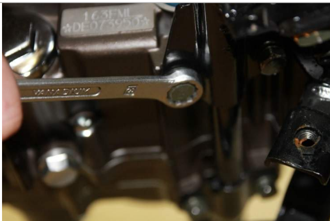
3.18.7. Затяните ключом болты крепления подножек.
