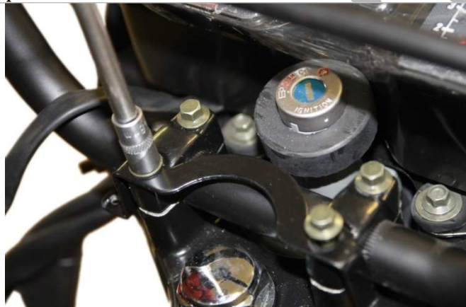
3.1.5. Отрегулировав руль в нужное положение, закрутите болты крепления.
