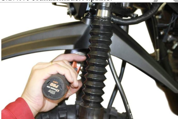
3.17.11. Закручиваем болты крепления переднего крыла.
