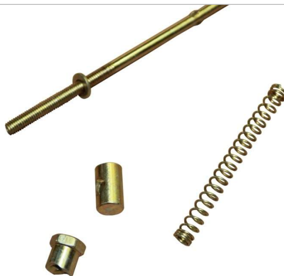
3.19.6. Снимаем с тяги гайку, бобышку и пружину, оставляя только шайбу.
