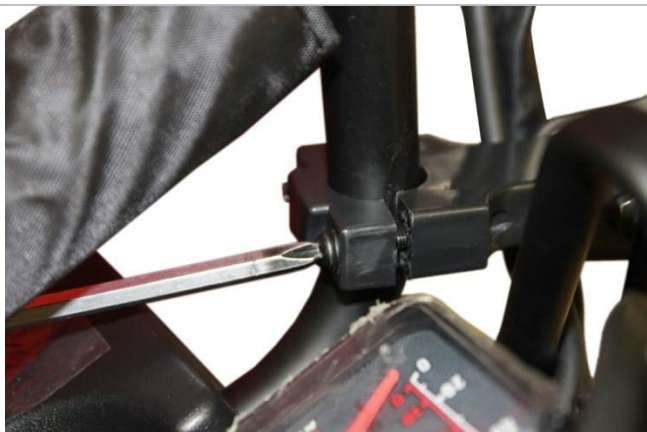
3.24.5. Фиксируем болтами кронштейн защиты ручки руля.
