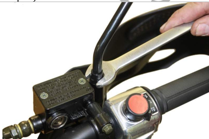
3.25.2. Зафиксируйте гайки ключом.
