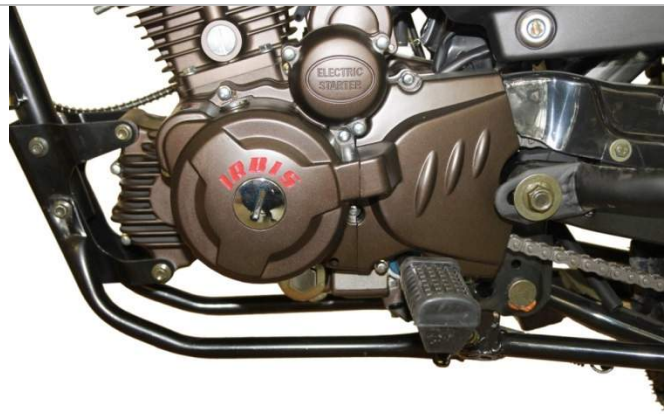
3.18.8. Установите на место и закрутите элементы защиты двигателя.
