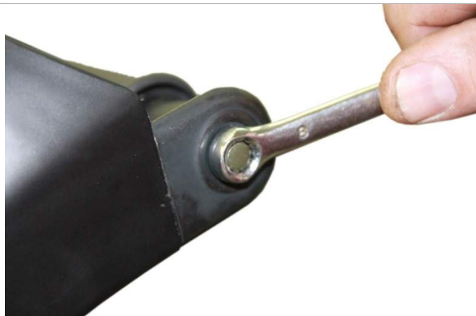
3.24.6. После того, как защита установлена, докручиваем все болты защиты ручек руля.
