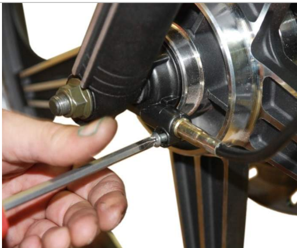
3.17.7. Устанавливаем на место трос привода спидометра.
