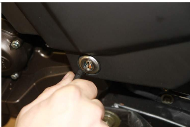
3.21.1. С помощью ключа замка зажигания открываем замок, крепящий боковой пластик.
