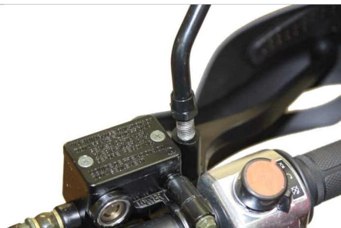
3.25.1. Вкрутите зеркала в штатные отверстия в блоках управления руля (с левой и правой сторон).
