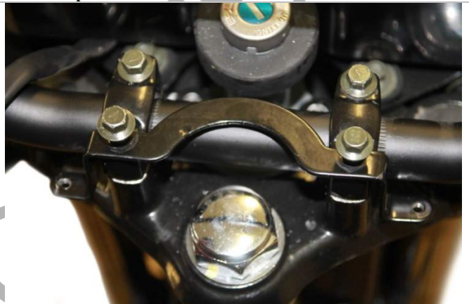
3.1.4. Установите кронштейн крепления указателя уровня топлива так, как указано на рисунке. Наживите нижние болты крепления.
