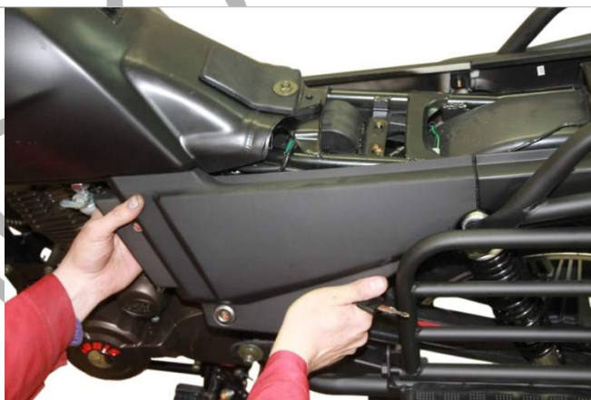
3.21.2. Снимите боковой пластик.
