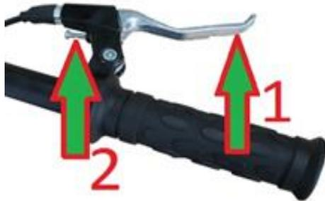
1. *Рычаг дросселя.* Для ускорения нажмите на рычаг дросселя. Для замедления отпустите рычаг дросселя. Перед запуском двигателя проверьте рычаг дросселя, убедившись, что он работает плавно. Удостоверьтесь, что рычаг возвращается в положение холостого хода, как только он становится свободным.
