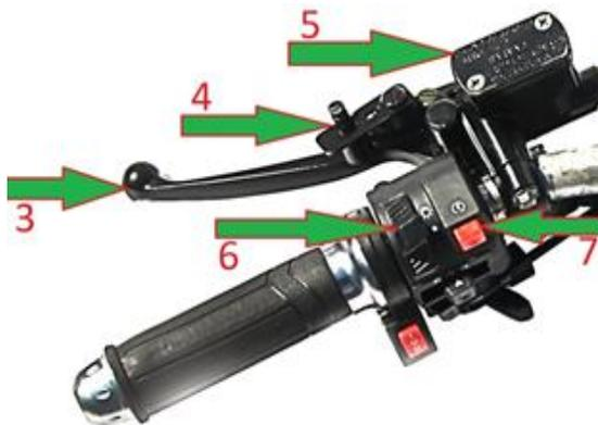
3. *Рычаг тормоза.* Нажатие на рычаг приводит в действие тормоз, служащий для остановки мотобуксировщика и его удержания на месте во время стоянки на склоне. Рычаг может использоваться вместе с фиксатором (поз. 4).
