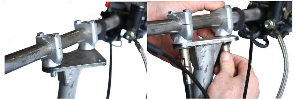
4. И демонтируем рулевую стойку мотобуксировщика (демонтаж указан в инструкции к мотобуксировщику).
